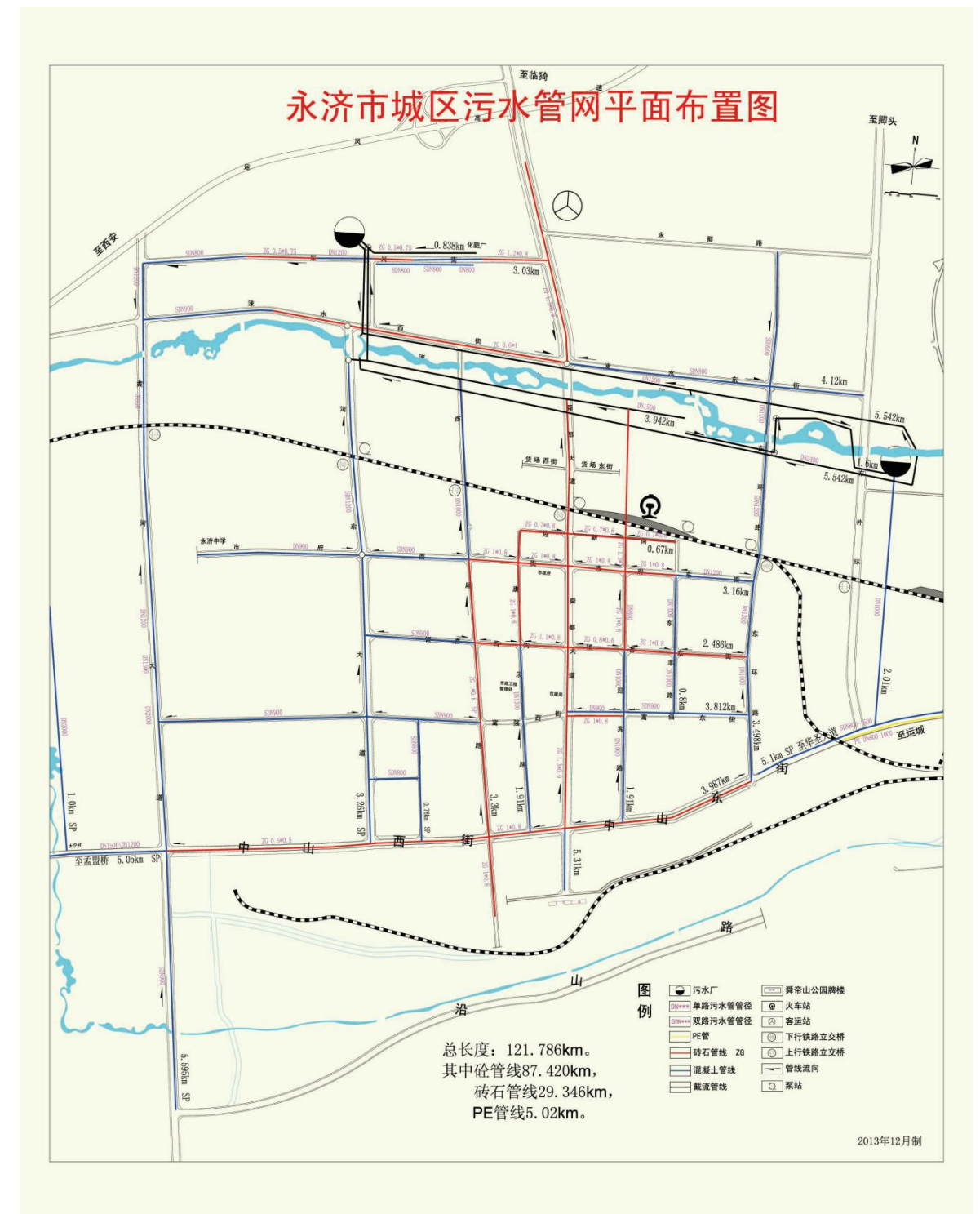
图 1.1-3 城区污水管网平面布置图
