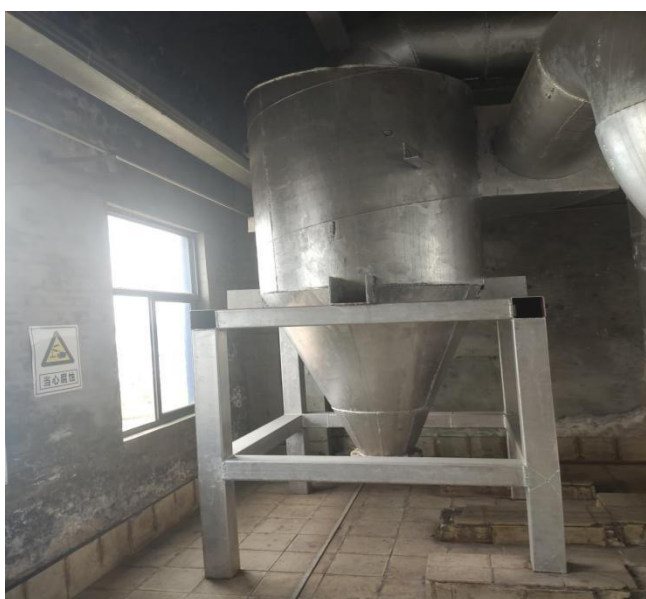
硫铵结晶干燥旋风除尘
